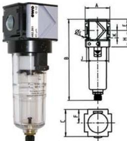
Il filtro di nuovissima concezione modulare, può essere usato singolarmente o come parte di ricambio dei gruppi Art. 3464 GCP - 3464 GCPA. Può essere fornito nella versione con scarico manuale o automatico. Porosità del filtro in polietilene  $\mu\text{m}$  40. Bicchiere in robusto policarbonato trasparente, infrangibile, a sgancio rapido, per resistere a temperature fino a 50 °C e a pressioni fino a 16 bar.
